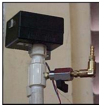
FIGURA 2. Mecanismo para avaliação da resposta do tensiômetro eletrônico a uma ruptura instantânea do vácuo.
