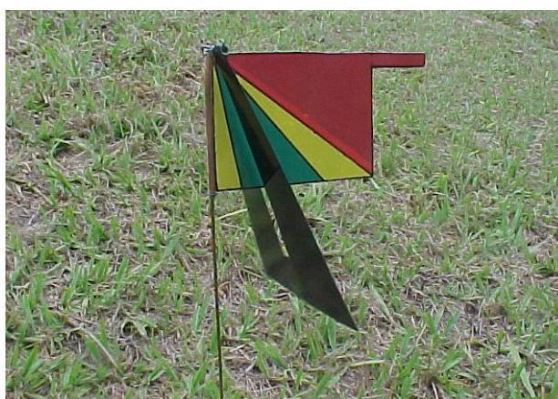
Figura 1. Protótipo do indicador de velocidade do vento
