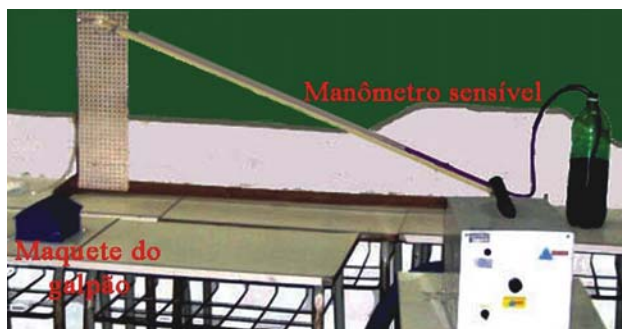
Figura 2 - Fotografia do arranjo experimental para investigar os efeitos do vento em um galpão rural.
