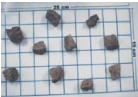
Foto 14 - Exemplos de estrutura grande em blocos angulares
