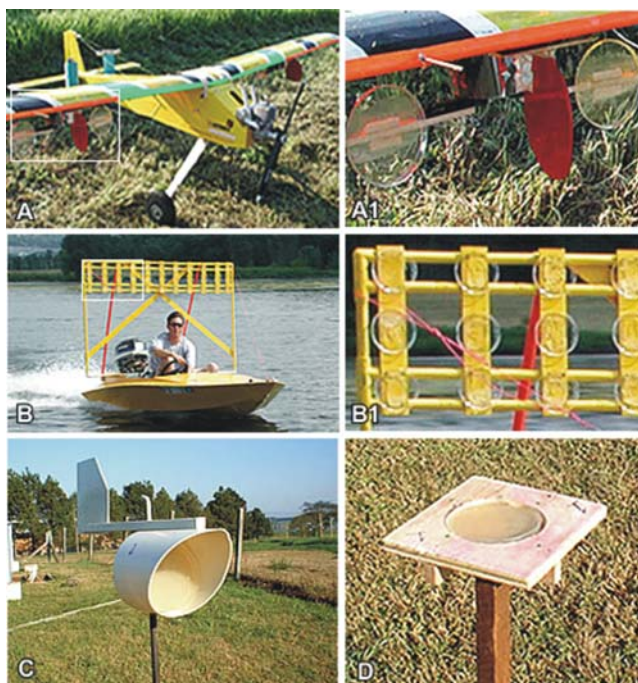
FIG. 2 - Tipos de armadilhas caça-esporos utilizadas para coletar inóculo aéreo de Gibberella zeae : aeromodelos (A) e detalhe da placa acoplada no aeromodelo (A1); armadilha vertical sobre barco a motor (B) e detalhe do suporte das placas (B1); armadilha do tipo cata-vento (C); e armadilha tipo plataforma horizontal (D). Fotos A, A1, B e B1: cortesia de David Garner Schmale.
