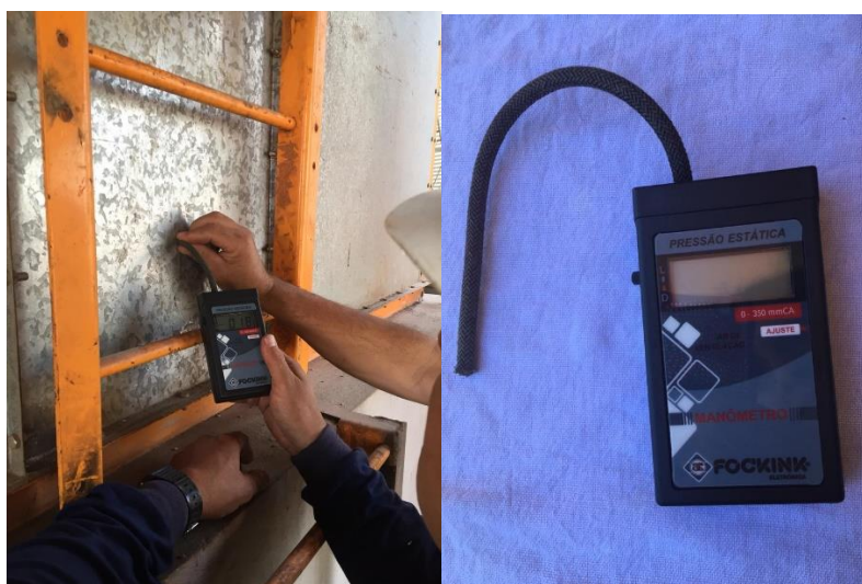
Figura 16 - Coleta da pressão através do manômetro
