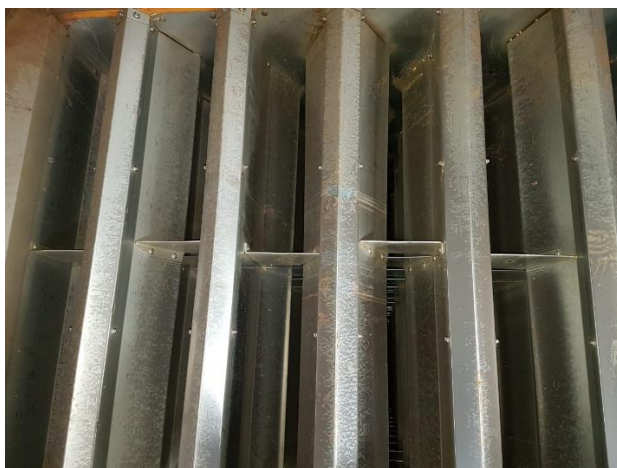
Figura 13 - Calhas do secador investigado (visão superior)
