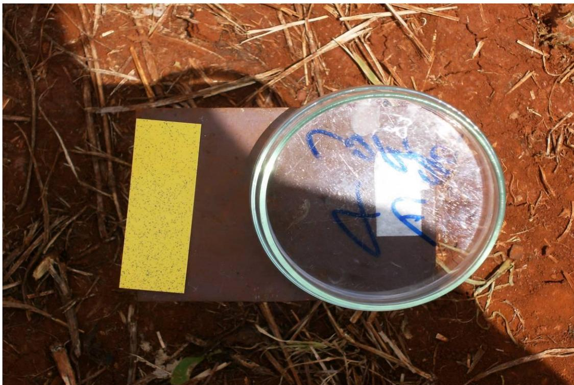
Figura 5. Alvo coletor da deriva (placa de Petri)
