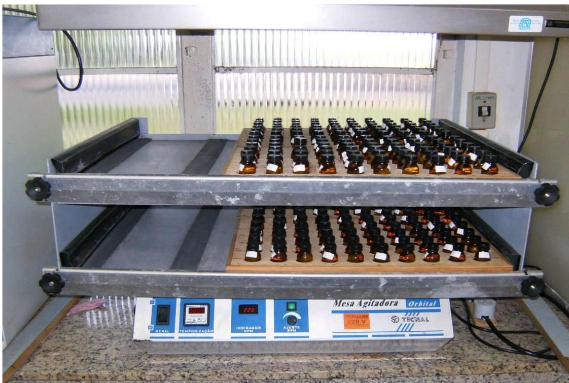
Figura 6 . Mesa agitadora para recipientes contendo alho e solução extratora.
