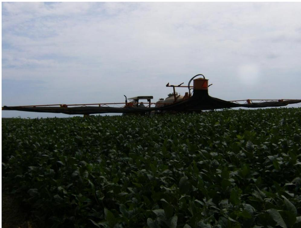
Figura 1. Pulverização na cultura da soja sem assistência de ar na barra (convencional)
