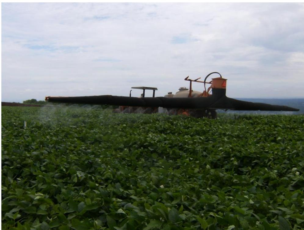
Figura 2. Pulverização na cultura da soja com assistência de ar em barra
