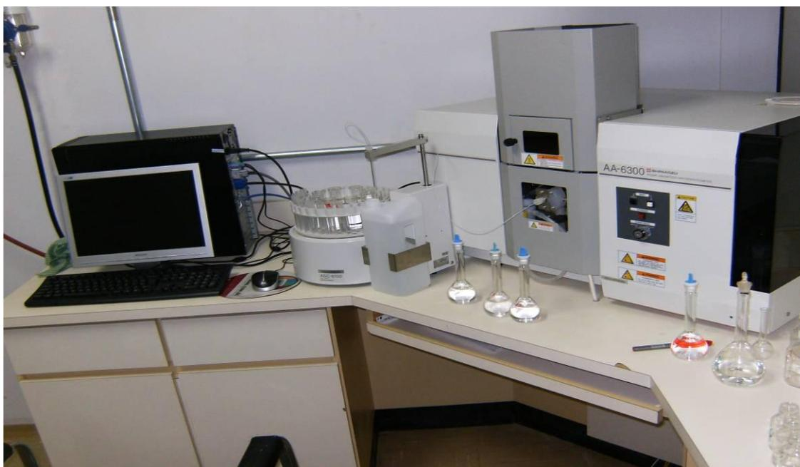
Figura 7. Espectrofotômetro de absorção atômica, modelo AA-6300 SHIMADZU para quantificação do íon cobre (Cu).
