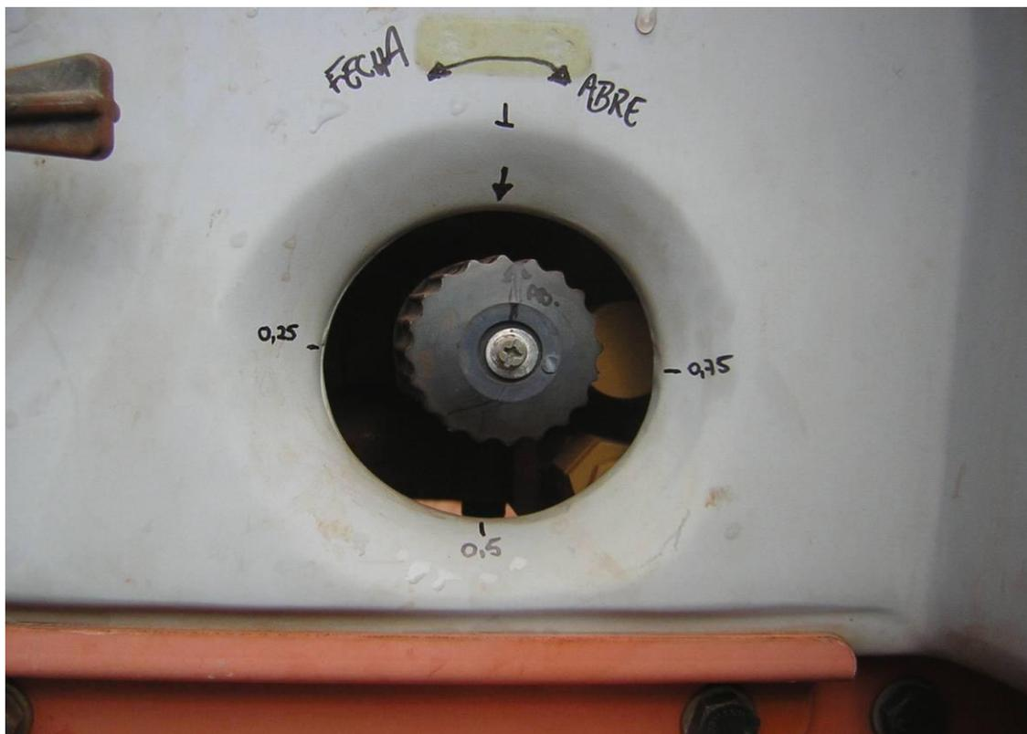
Figura 3. Dispositivo para regulagem da velocidade do ar gerado pelo ventilador do pulverizador.
