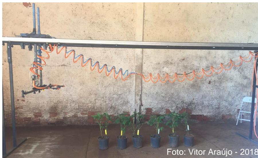
**Figura 4 - Aplicação de chuva simulada sobre planta de soja tratada com calda fungicida posicionada dentro do recipiente coletor e com a base do vaso envolvida por saco plástico**
